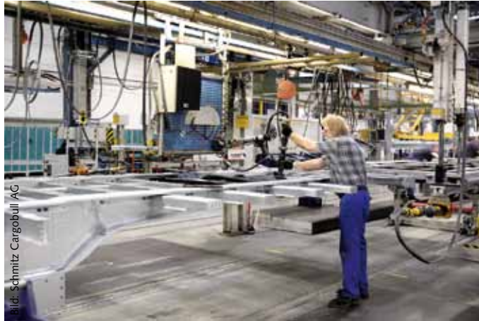
Hart im Nehmen: Verbolzen von stückverzinkten Chassisbauteilen (in der Nutzfahrzeugindustrie)
